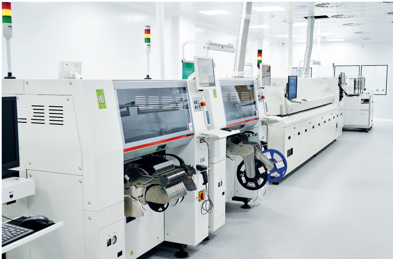
Линия FLEX:SMT на новом производстве
